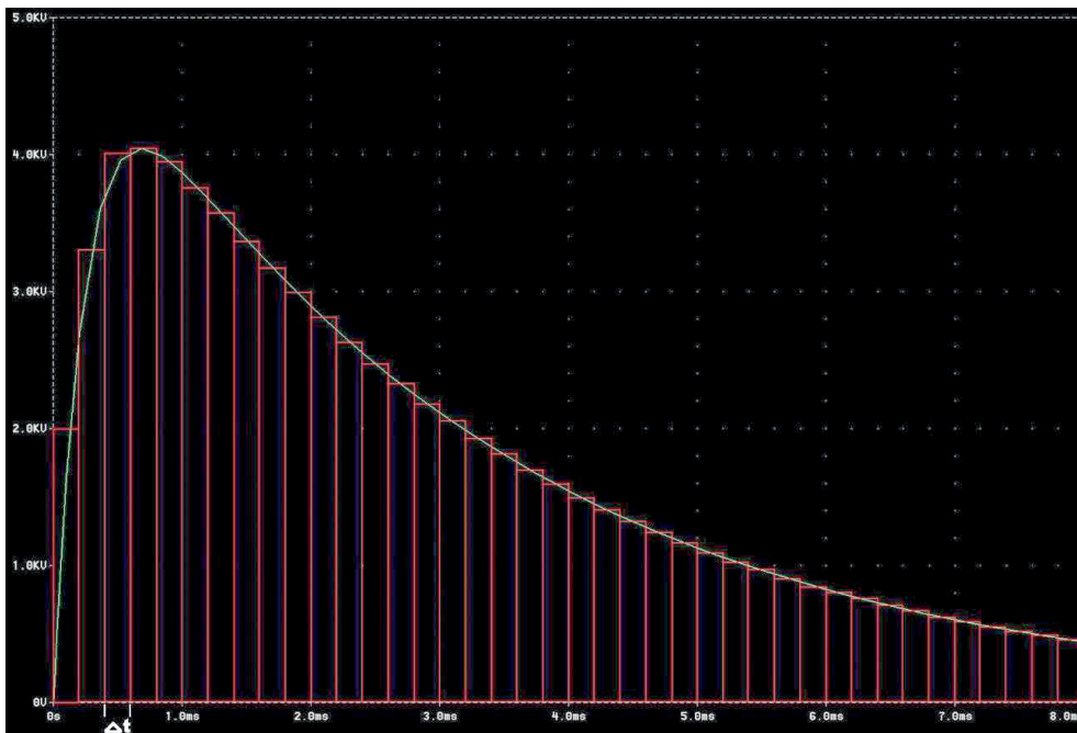
Abbildung 4-2: Entladekurve über internen 100 \Omega Widerstand
